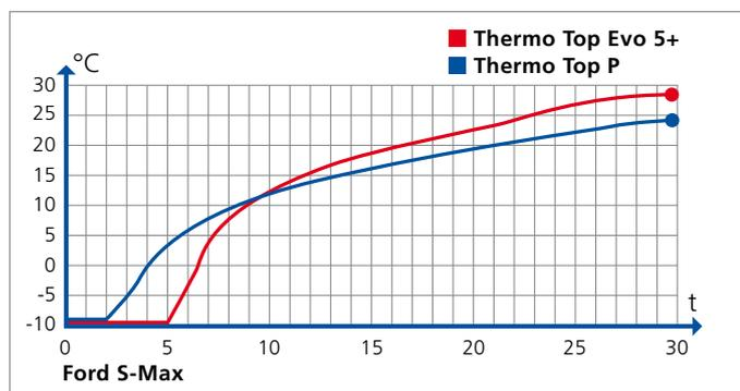
In der Kältekammer wird das Testfahrzeug (Ford Galaxy 2.0 TDCi) acht Stunden lang auf -10 °C durchgekühlt und die Windschutzscheiben definiert vereist. Sobald die Standheizung in Betrieb geht, werden Innenraumtemperatur und Scheibenenteisung gemessen.
